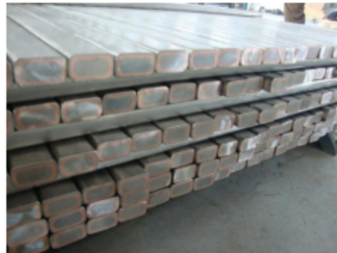
b) 钛铜钢复合矩形棒成型件
