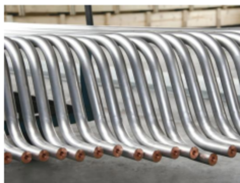
d) 钛铜复合圆棒成型件
